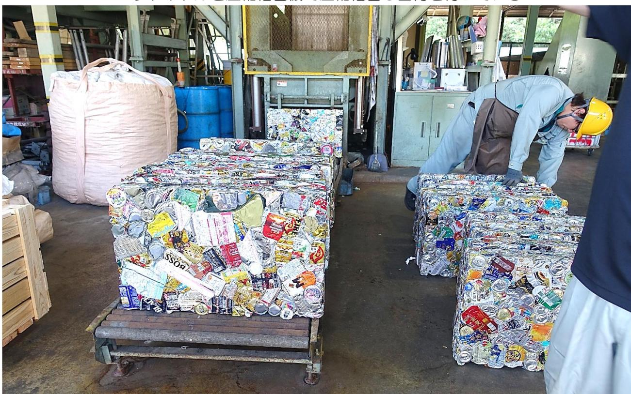
不適物を除去した缶を、磁力選別機でスチール缶とアルミ缶に選別。金属圧縮機で圧縮成形し、屋外のストックヤードに貯留されている。
